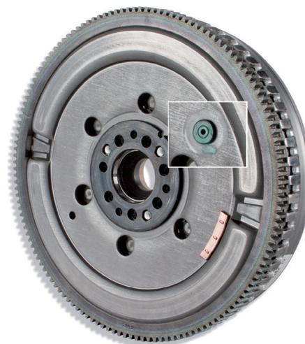
画像 1：エンジンが初めて作動すると、DMF 内の輸送固定具が剪断されます。
